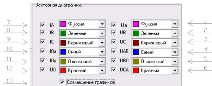
Рисунок 71 – Назначение в окне «Измерение и контроль» программы «RZA_config» отображаемых векторов и их цвета на диаграмме
