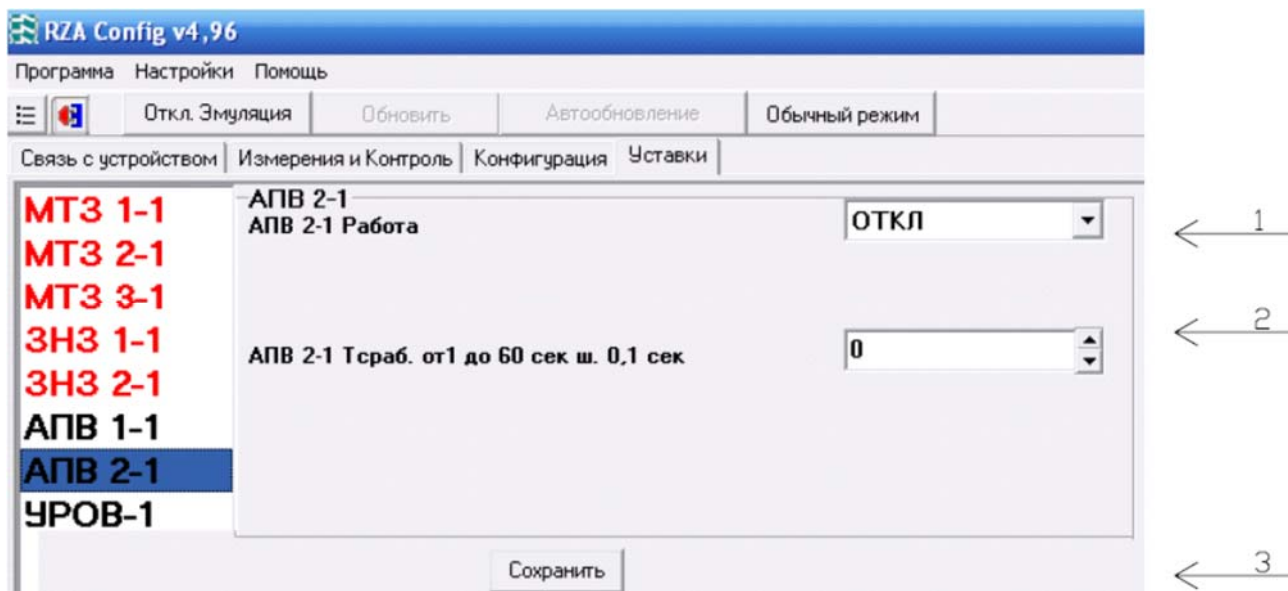
Рисунок 50 – Окно выбора уставок и параметров АПВ2 в программе «RZA_config»
